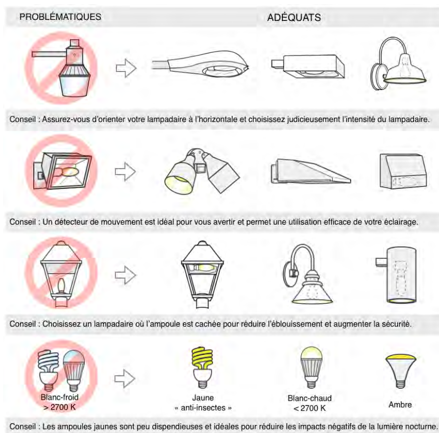
Figure 145 : Types de luminaires problématiques et adéquats
