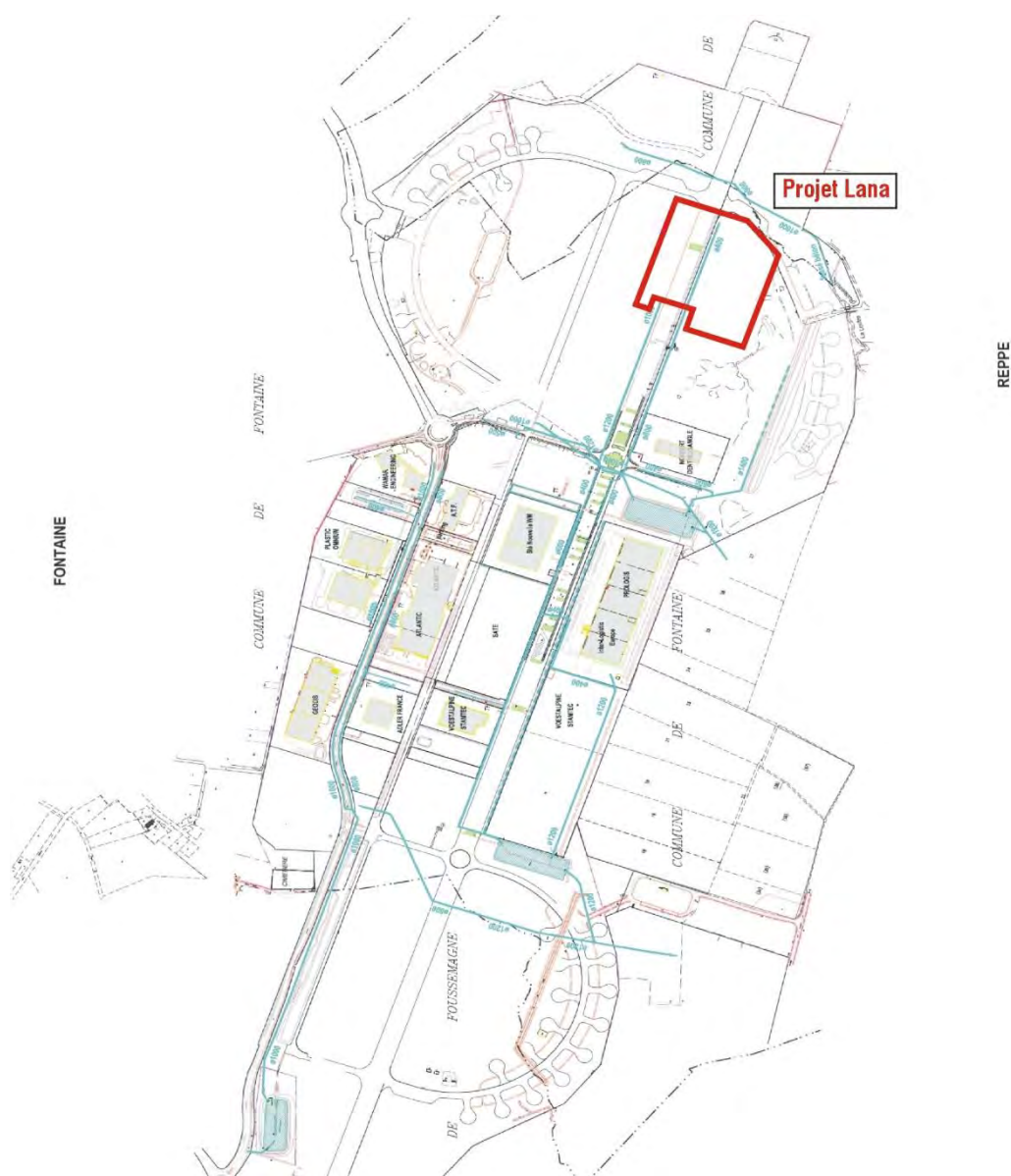
Figure 96 : Extrait du plan du réseau d'eaux pluviales à l'échelle de la ZAC de Fontaine
