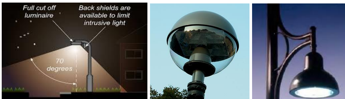
1.- Exemple de luminaire « full cut-off » avec installation d'un dispositif opaque (coupe flux) pour limiter l'éclairage dans les endroits non fréquentés ou nécessitant d'être préservés de la pollution lumineuse. / 2 & 3.- Lampes bafflées.
